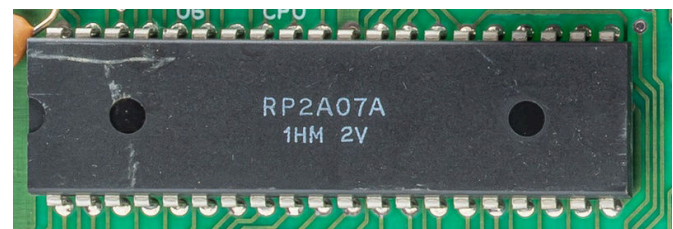
Fig. 8 - La CPU prodotta da Ricoh per il Famicom/ NES, qui in versione PAL (autore: PantheraLeo1359531 - fonte: Wikimedia Commons)
